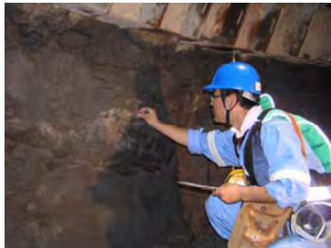
立坑壁面観察状況
